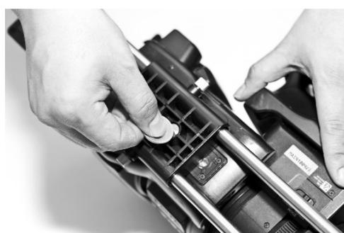
3. 字型スライド(ML-SL30)をカメラ／三脚取付アダプター(ML-AT1)のスライド穴に挟んで結合させた後スライド固定用ねじで動かないように締めます。バッテリー(ML-BA12)の L字形スライド取付穴に L字形スライド(ML-SL30)を挟んで取付けた後、バッテリーの12V DC IN/Out 端子と LED ライト
