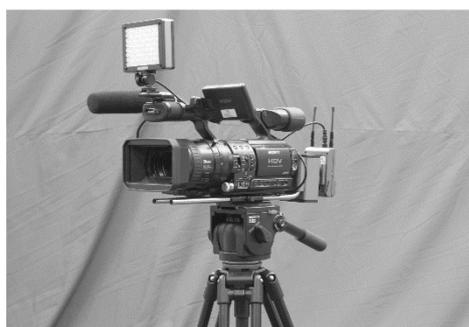
△ 注意: (ML-AT1)を利用してカメラを 三脚取付に据え置きした後移動する際には必ず三脚取付をカメラから分離したり、しっかり持ちながら移動してください。カメラだけを持ち運ぶ場合、ML-AT1の 三脚取付全体の荷重により部品が破損される可能性があります。
